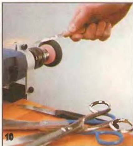
10 Оправка с зажатим шлифовальным кругом позволяет затачивать ножницы и ножи.
