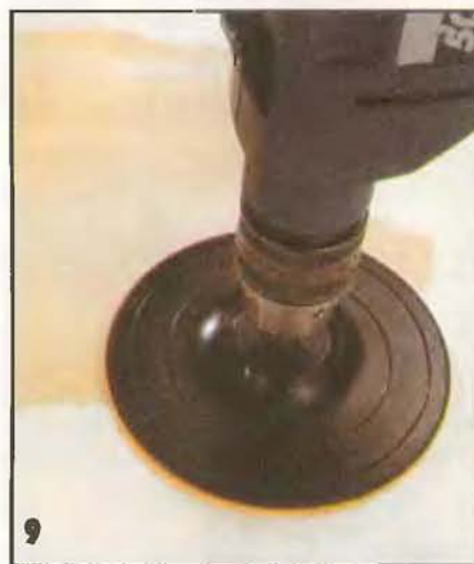
9 Эластичная тарельчатая шлифовальная насадка эффективно удаляет старую краску.
