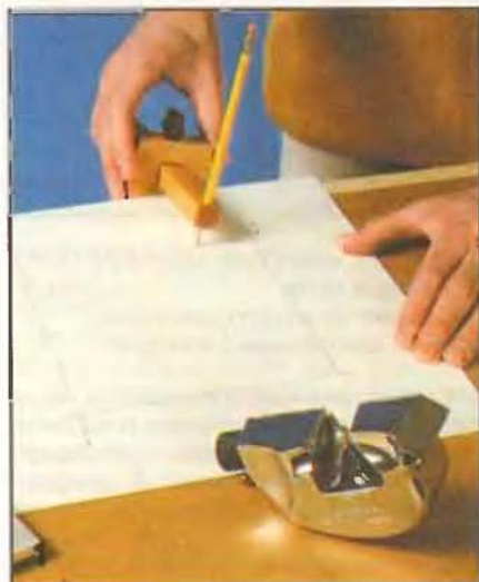
Карандашом с помощью рейсмуса размечают проем.
