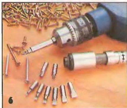
6 Держатели-переходники для сменных отверток: магнитный и с проскальзывающей муфтой (справа). Их тоже можно зажать в патроне электродрели.
